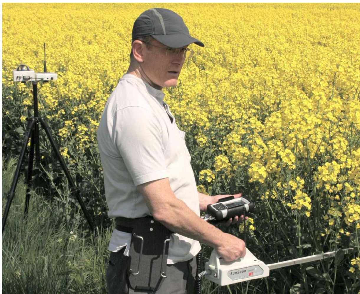
System SunScan z kontrolerem PDA w wersji z łączem radiowym pomiędzy sondą SunScan a zewnętrznym czujnikiem BF5 (SS1-COM-R4).
