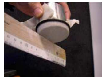
Rys. 39. Usuń nadmiar wody z próbki
