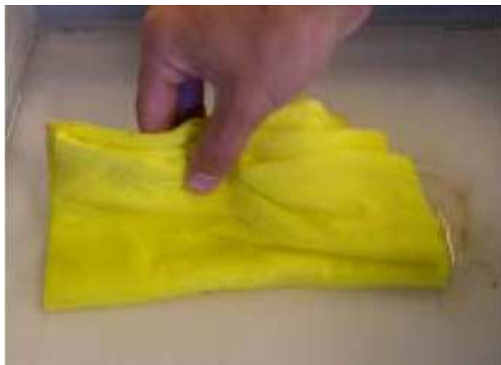
Rys. 41 Oczyszczyć i wygładzić powierzchnię kaolinu za pomocą gąbki
