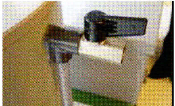
Rys. 12 Otwórz zawór spustowy ciśnienia
