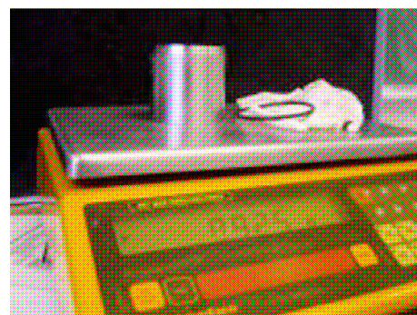
Rys. 46 Ważenie pierścienia, gazy i gumki
