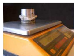
Rys. 39. Usuń nadmiar wody z próbki
