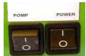
Rys. 14 Pompa jest wyłączona
