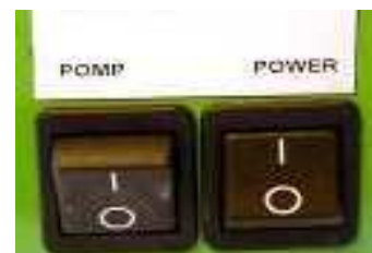
Rys. 42 Pompa jest wyłączona
