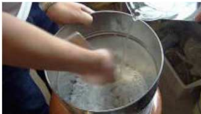
Rys. 16 Piasek nasycamy wodą
