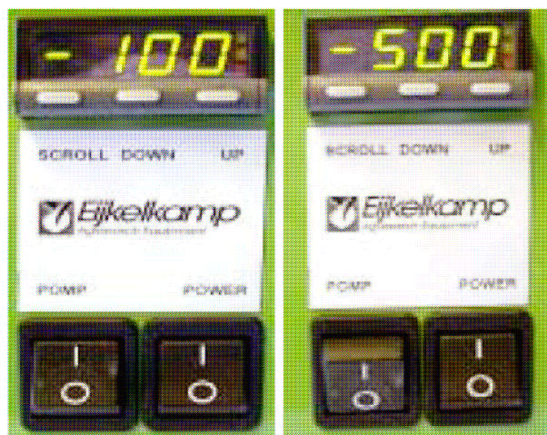
Rys. 24 Zmiana parametru „AL” na – 500
