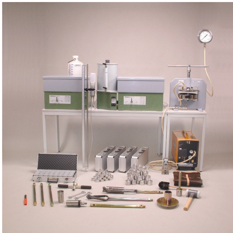
Zestaw do określania charakterystyki pF – aparat piaskowy (pF 0 – 4.2)
