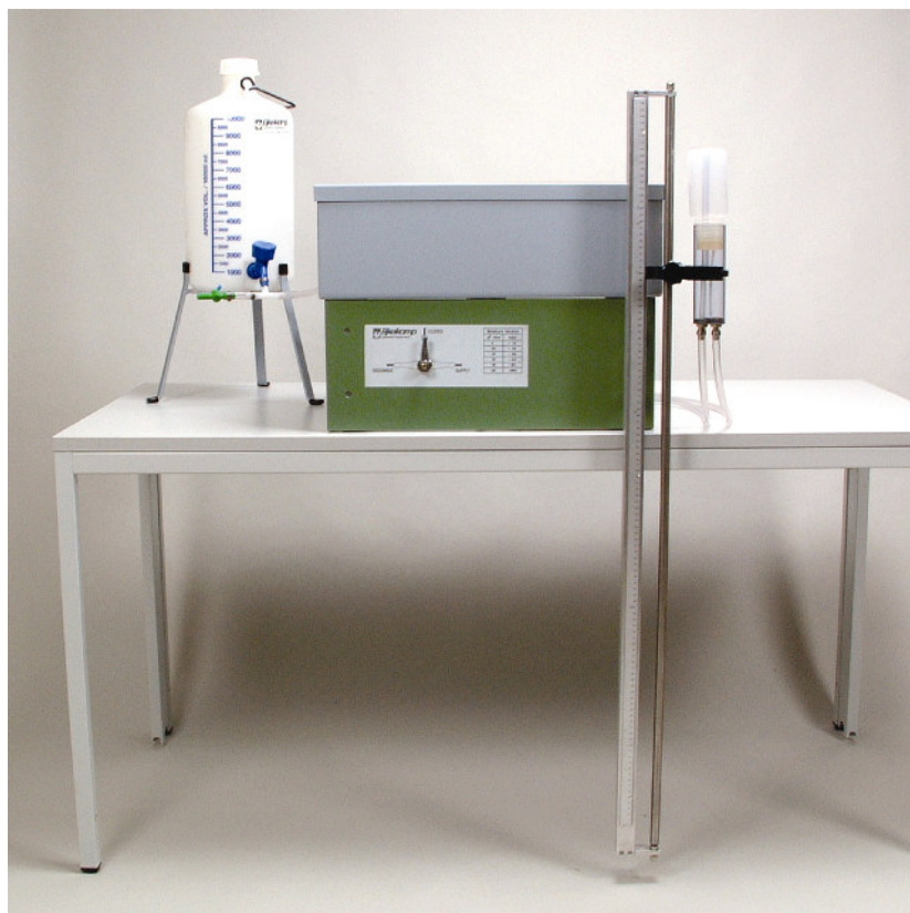
Aparat piaskowy do określania pF (zakres pF 0 – 2.0)
