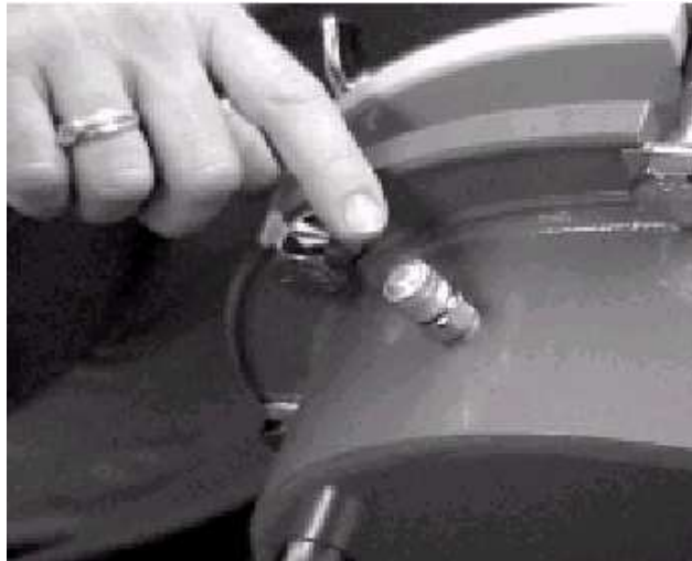
Rys. 6 Osłona gwintu na dolocie ciśnienia
