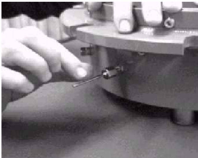
Rys. 10 Podłącze rury odlotowej jest wkręcane w specjalny otwór
