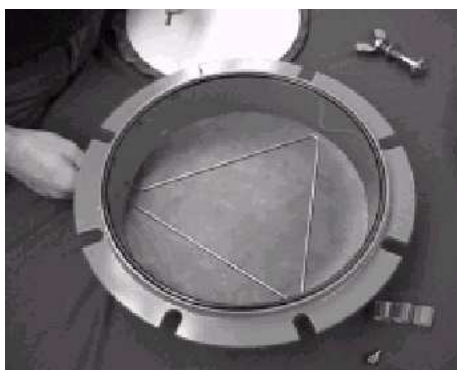
Rys. 14 Wspornik trójkątny umieszczony na dnie ekstraktora
