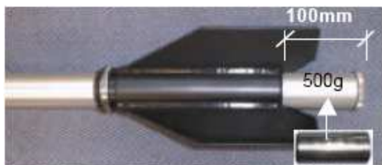
Długa płetwa sterująca, 100 kg , 840 mm + 500 mm przeciwwaga 500 g.
