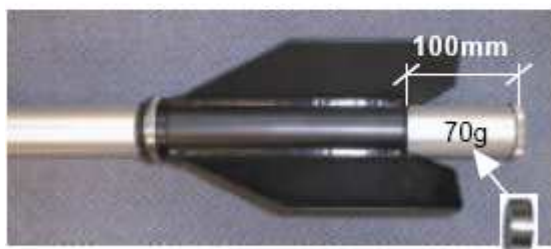
Długa płetwa sterująca, 50 kg , 840 mm + 500 mm przeciwwaga 70 g.
