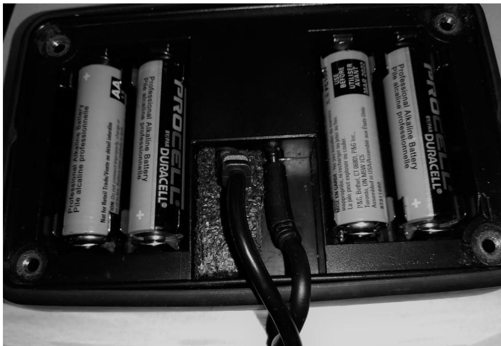
Rys. 1 Kabel podłączony. Podkładka piankowa założona.
